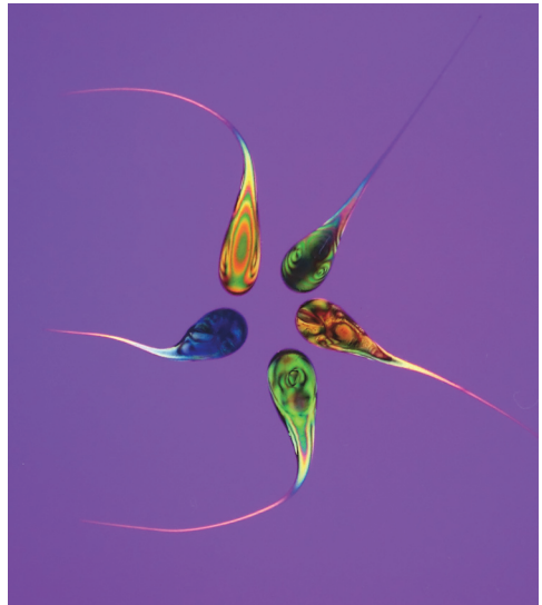
図6-1 ひずみ検査器で見たプリンス・ラパートの滴
